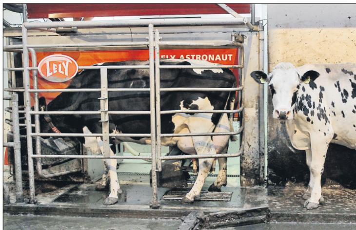
Im Melkroboter lockt das Kraftfutter. Nach dem Milchentzug klappt der Trog zurück, die Tür öffnet sich und die Kuh kann die Station verlassen.
