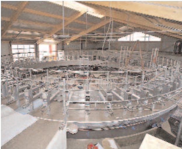
Das 60-er Rotary-Außenmelker-Karussell besticht durch eine enorme Stundenleistung.
