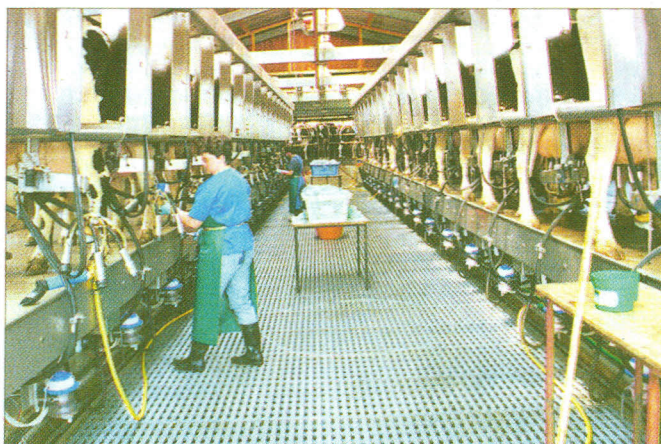
Im Fischgrätenmelkstand mit zweimal 16 Plätzen und Schnellaustrieb läßt sich eine hohe Arbeitsproduktivität erreichen.
